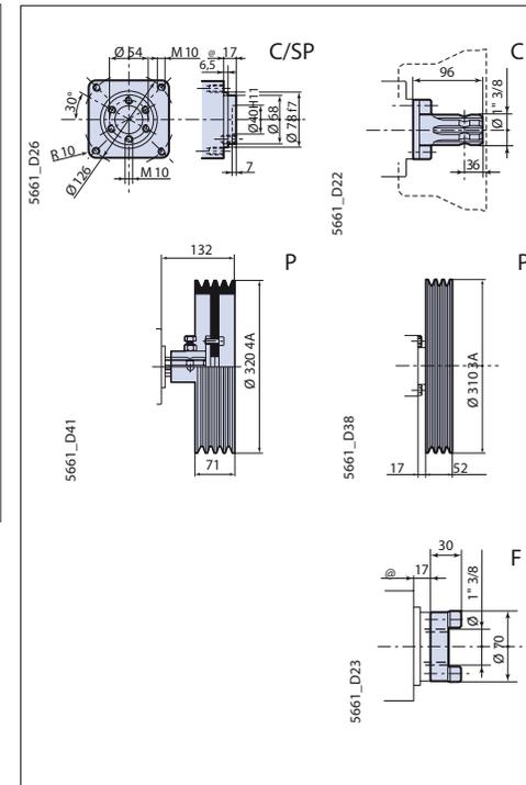
Bei den C/SP Pumpen verringert sich das Maß @ 17 auf 15 bei dem auf den Pumpenkörper montierten Flansch des Dichtungsring. Anmerkung: Den Dichtungsring mit Kode 1400140 vor der Anknüpfung des Untersetzungsgetriebe an die Pumpe entfernen.
