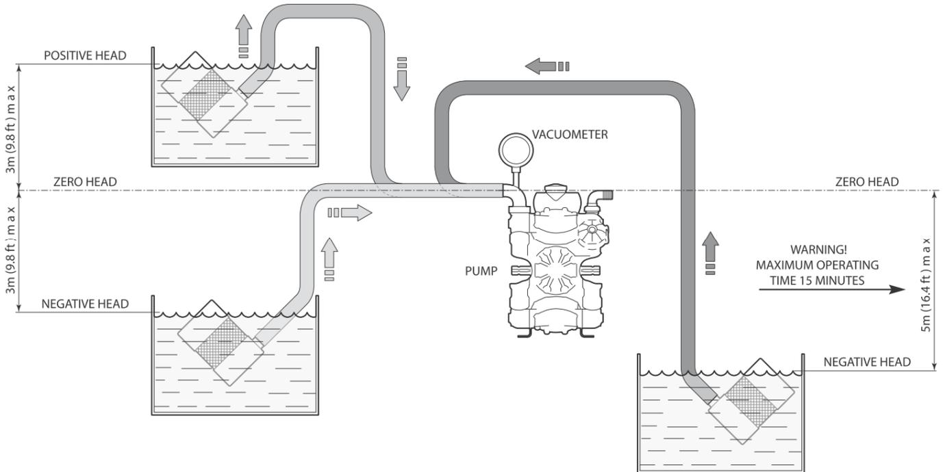
Не допускается установка насоса выше уровня воды более 3 метров. Шланги, используемые в системе подачи рабочего раствора должны использоваться в соответствии с размерами патрубков, установленных на насосе (см. Технические данные)
